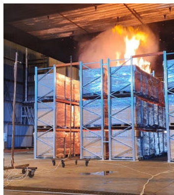
Déclenchement de sprinkleur avec phénomène d'inflammation du glycol
