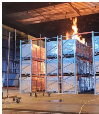
Développement de l'incendie pendant les 2 premières minutes Déclenchement de sprinkleur avec phénomène d'inflammation du glycol
